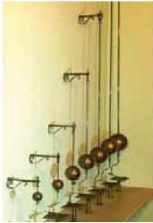
30. ábra. A korai szeizmométerek egyszerű ingák voltak (© BGS / NERC Paul Denton)
