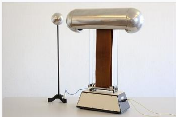
Iskolai Van de Graaff-generátor (Léptetés a sorszám melletti gombokkal)
